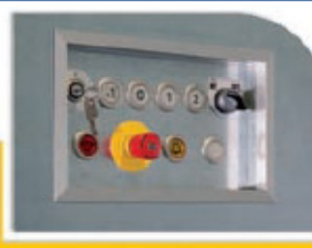
Botonera en cabina de pulsación constante, retranqueada y protegida por un marco para evitar daños en las operaciones de carga. Compuesta por: indicador pesacargas, llavín habilitador (con preferencia de uso), stop de emergencia, botón de alarma, luz de emergencia y selector luminoso para maniobra de antiderivas (opcional).
