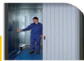
Puerta de lamas manual o automática, la mejor solución cuando se requiera dejar libre la zona de embarque. Puede utilizar el espacio existente entre las guías y la pared del hueco. Lamas de alta resistencia gracias al grosor de 40mm. Paso Libre entre 1200 y 3000mm y Altura Libre entre 2000 y 2500mm. Para más información, consultar Especificaciones Técnicas.
